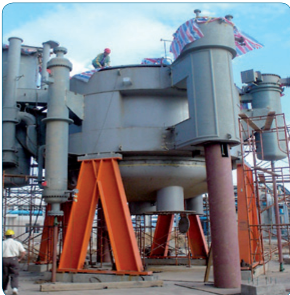
Abbildung 11: Salzbadreaktor DWE® Reactors (Quelle: MAN DWE GmbH)
