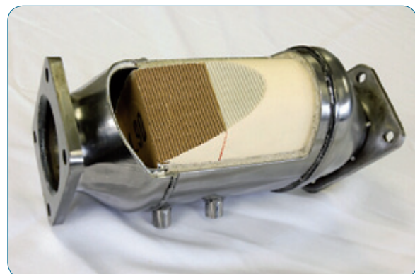
Abbildung 21: Autoabgaskatalysator mit keramischem Monolithen (Quelle: Umicore AG & Co. KG)
