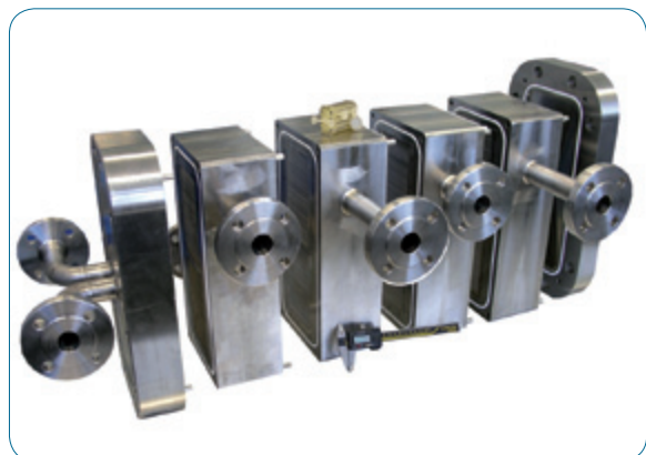
Abbildung 13: Mikrostrukturierter Produktionsreaktor des IMVT zur Synthese von Diacetonacrylamid aus Diacetonalkohol und Acrylnitril. Der Reaktor ist aus Hastelloy C-22 gefertigt, diffusionsgeschweißt und besteht aus einem Mischmodul und vier Reaktionsmodulen. Er erreicht reaktionsseitig einen Durchsatz von ca. 1.5 t/h und war bei DSM Fine Chemicals Austria in Linz für mehrere Kampagnen über viele Wochen im Einsatz. (Quelle: Institut für Mikroverfahrenstechnik (IMVT), Karlsruher Institut für Technologie (KIT))
