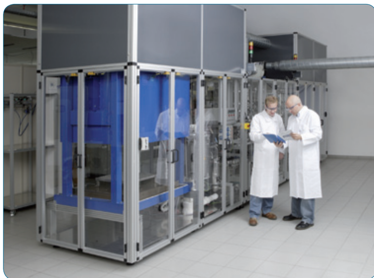
Abbildung 4: Hochdurchsatzreaktor für die Kraftstoffaufbereitung im Pilotmaßstab (Quelle: hte Aktiengesellschaft)
