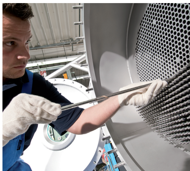
Ozonelektrodenbestückung (© Xylem Inc.)
