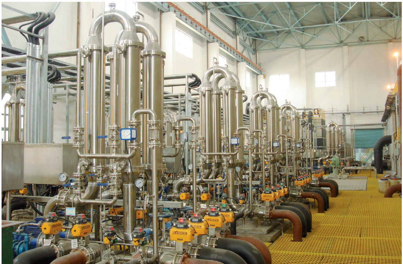
Wasserrückgewinnung in der Stahlindustrie (© atech innovations gmbh)
