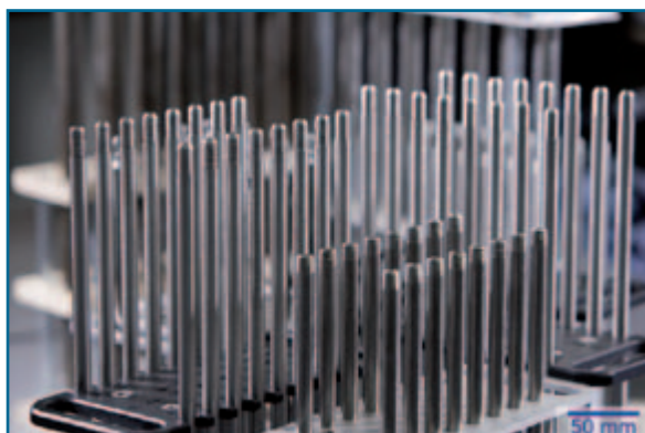
Abbildung 15: Verschiedene Strömungsrohrreaktoren vor Einbau in die Hochdurchsatz-Anlage (Quelle: hte AG)
