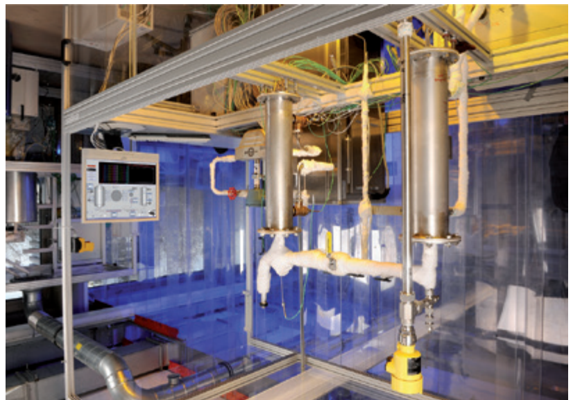
Abb. 110: Testsystem für chemische Wärmespeicher (Quelle: DLR e.V.)
