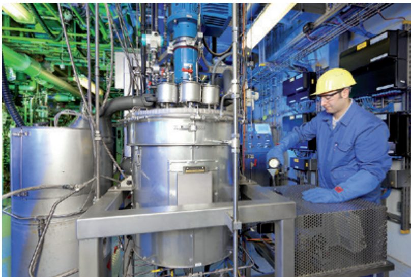
Abb. 16: Fertiggestellte Mini-Plant- Anlage für die Produktion von CO 2 -haltigen Polyolen.
