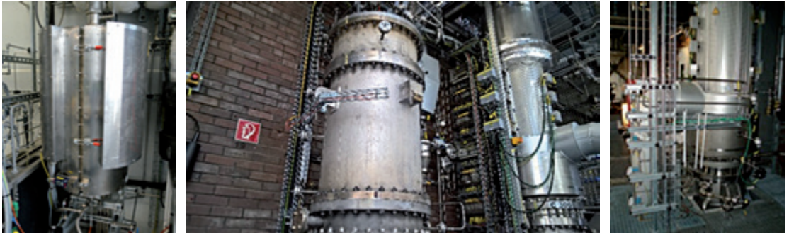
Abb. 30: Versuchseinrichtungen zur Hochtemperatur-Pyrolyse im Labor- und Technikumsmaßstab, Start in 2014 und 2015
