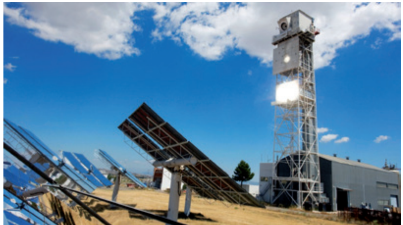
Abb. 72: Testeinrichtung zur Erprobung von Receiversystemen (Quelle: DLR/Ernsting)
