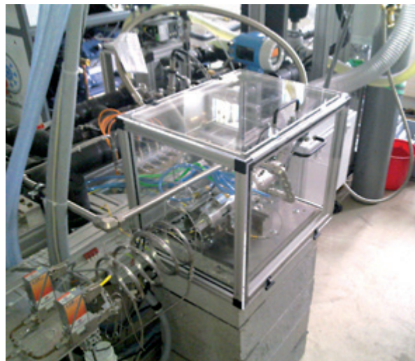
Abb. 87: Prüfling in seiner Entlüftungsbox im CO 2 -Kreislauf
