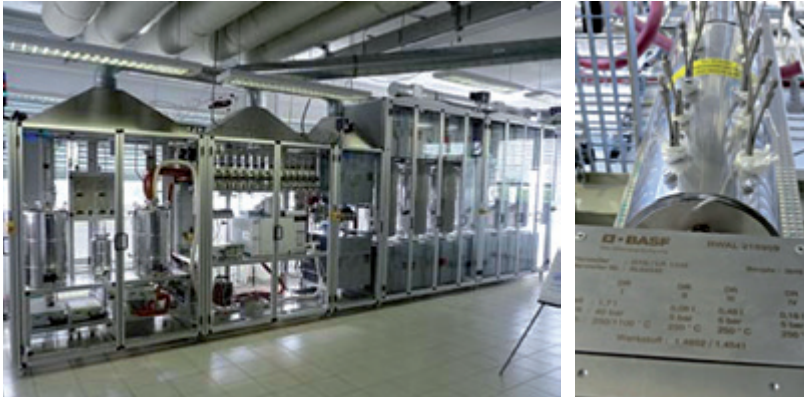
Abb. 32: Versuchseinrichtungen zur Katalysatorentwicklung der reversen Wassergas-Shift-Reaktion für die CO 2 -Aktivierung, Start in 2014 und 2015
