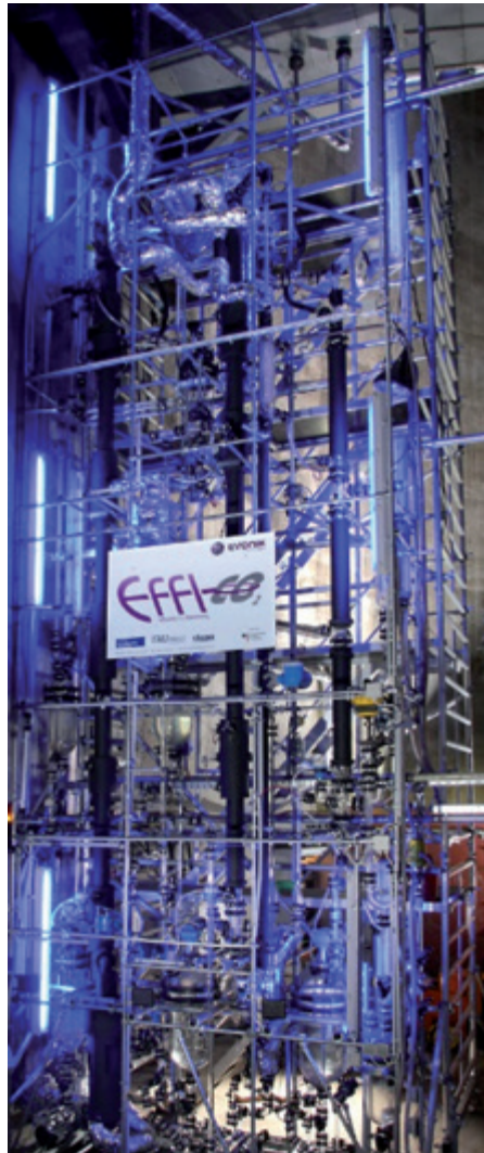
Abb. 86: Versuchsanlage im Schornsteinfuß des Heizkraftwerkes in Herne bestehend aus einer Waschkolonne, einer Absorptionskolonne sowie einer Desorptionskolonne.
