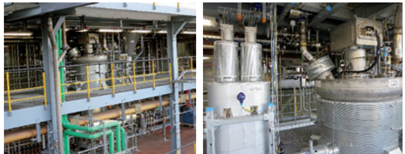
Abb. 31: Testchargenanlage für die Produktion von Kohlenstofftestchargen, Start in 2016
